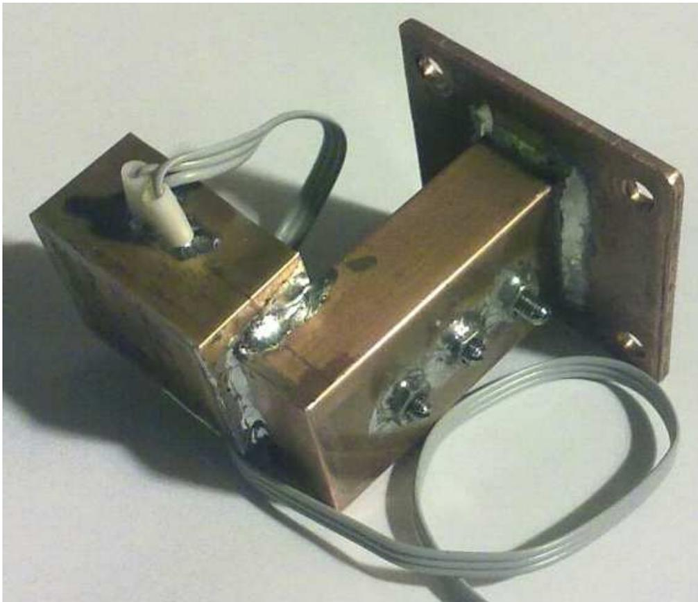
Fig. 9. The test LNA 10 GHz.
