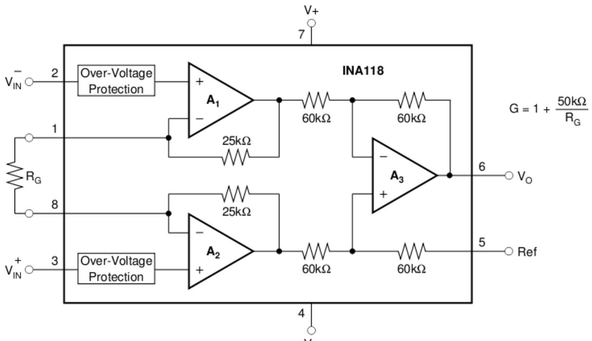
Output voltage:  $g(V_2 - V_1) + \frac{1}{2}|A_{cm}|(V_2 - V_1)$
