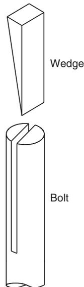
Fig. 28.6 Wedge and slot bolt.
