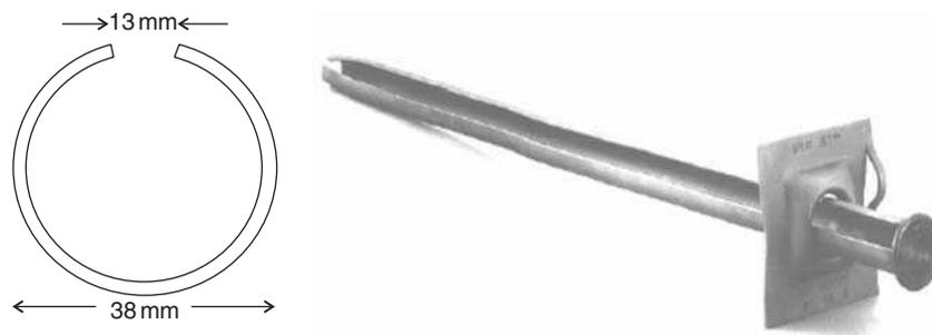
Fig. 12.5 Split set tube bolt.
