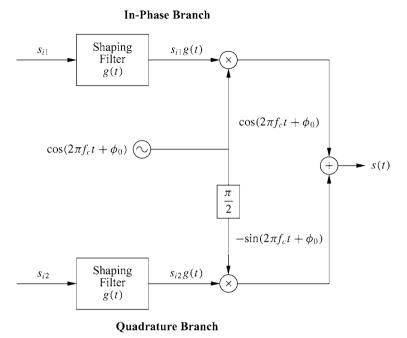
Figure 5.10: Amplitude/phase modulator.
