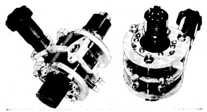
Fig. 16.5.—Photograph of the Sperry 410-R klystron.
