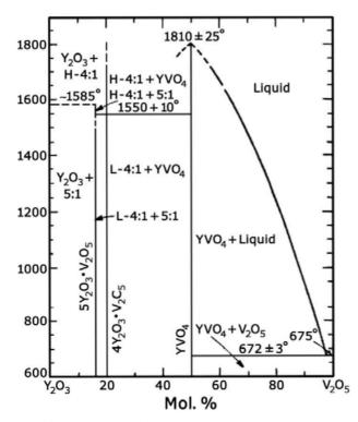
**Fig. 10.1.**  $Y_2O_3 - V_2O_5$  binary system [10]
