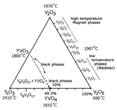
**Fig. 10.2.**  $Y_2O_3 - V_2O_5 - V_2O_3$  ternary system [26]
