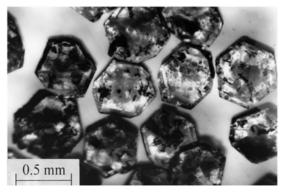
Fig. 17.10. Emerald crystals grown from  $MoO_3$ - $B_2O_3$  flux
